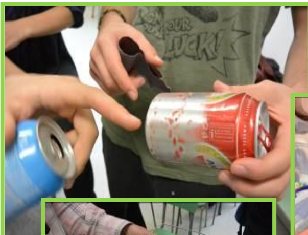
Μεταποίηση αλουμινένιων κουτιών αναψυκτικού σε καμινέτα οινόπνεύματος
